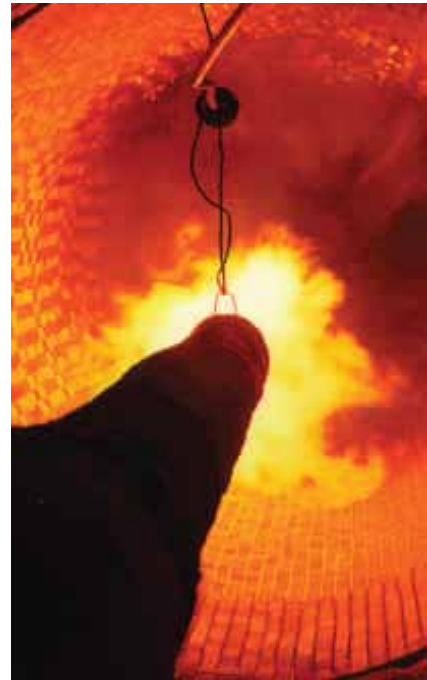
Bên trong một lò xi măng, nơi nhiệt độ lên đến trên 1400°C (2550°F)
