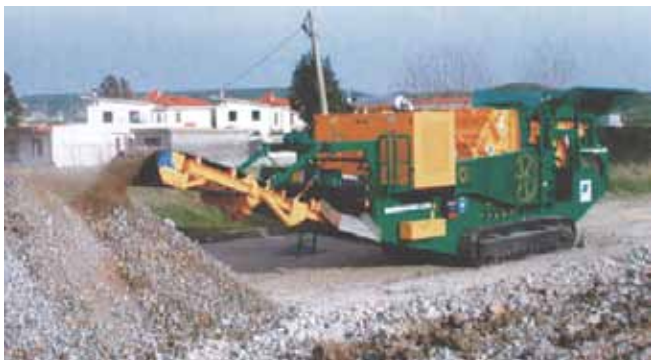
Ejemplo de un equipo móvil con trituradora de impacto. Los materiales aptos para este grupo móvil son las piedras naturales, escombros, asfalto y gravilla
